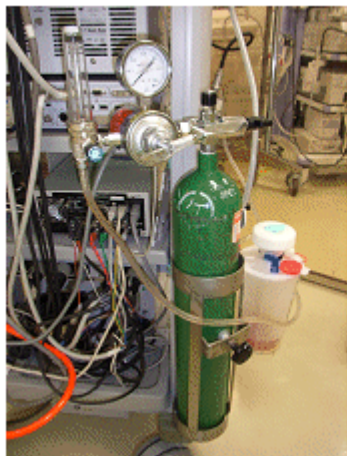
図1-a、エアウォーター株式会社製二酸化炭素レギュレーター
