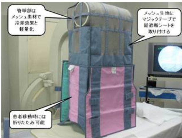
図1 遮蔽シートを4方向に取り付けた透視装置方法
